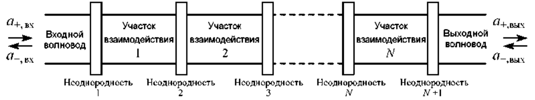
Рис. 2. Блок-схема ЛБВ в виде последовательно соединенных многополюсников
