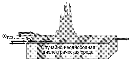
Рис. 2. Распределение интенсивности волны в среде для трех разных частот. Средняя частота соответствует резонансу, боковые частоты соответствуют «типичному», нерезонансному случаю
