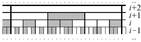
Рис. 1. Фрагмент иерархической системы модели дефектообразования. Каждый элемент i -го уровня состоит из n = 3 элементов (i - 1) -го уровня. Элементы системы могут быть исправны или дефектны (показаны заливкой). Состояние каждого элемента определяется состоянием образующих его элементов предыдущего уровня, а также его собственной восприимчивостью к дефектам. Рисунок соответствует ситуации s_2 = 1, s_1 = s_3 = 0 , то есть все элементы имеют одинаковую восприимчивость и становятся дефектными, когда дефектно более половины образующих их элементов
