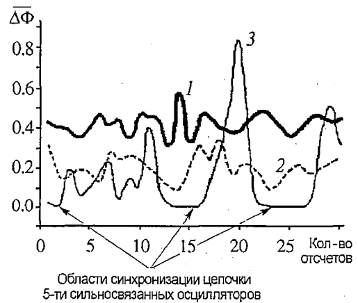
Рис. 6. Зависимость степени синхронизации двумерных цепочек осцилляторов Ресслера от степени связи между осцилляторами и количеством осцилляторов в цепочке для 50 несвязанных осцилляторов (кривая 1), 50 сильносвязанных (2) и 5 сильносвязанных осцилляторов (3)
