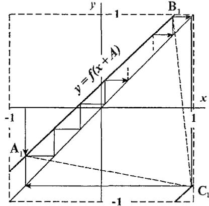
Рис. 3. Диаграмма Кенигса – Ламерея для отображения с нелинейностью и с переполнением
