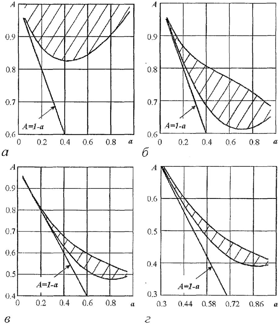
Рис. 4. Области существования паразитных периодических колебаний: а -  $T=2$ , б -  $T=3$ , в -  $T=4$ , г -  $T=5$
