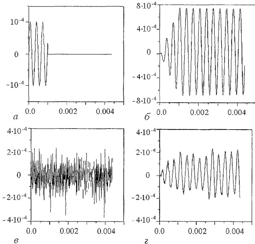
Рис. 3. Эпюры входных и выходных напряжений (В) в зависимости от времени (с): синусоидальный (а), шумовой (б) сигналы с амплитудой  $0.0001$  В и соответствующие им выходные напряжения (б, з) для неустойчивой точки на ВАХ при  $R_1=0.5$ ,  $R_0=0.1$ ,  $R=0.15$ ,  $L=1.44 \cdot 10^{-5}$ ,  $C=0.983 \cdot 10^{-4}$
