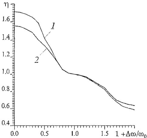
Рис. 4. Зависимость коэффициента частотных искажений  $\eta$  триггера от относительной расстройки частоты: 1 – амплитудная модуляция; 2 – частотная модуляция
