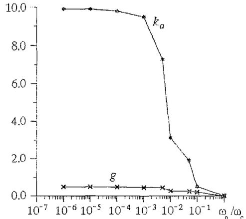
Рис. 5. Коэффициент усиления  $k_a$  и отношение  $g=SNR_{out}/SNR_{in}$  в зависимости от  $\omega_0/\omega_c$ . — отношения несущей частоты сигнала к собственной частоте контура
