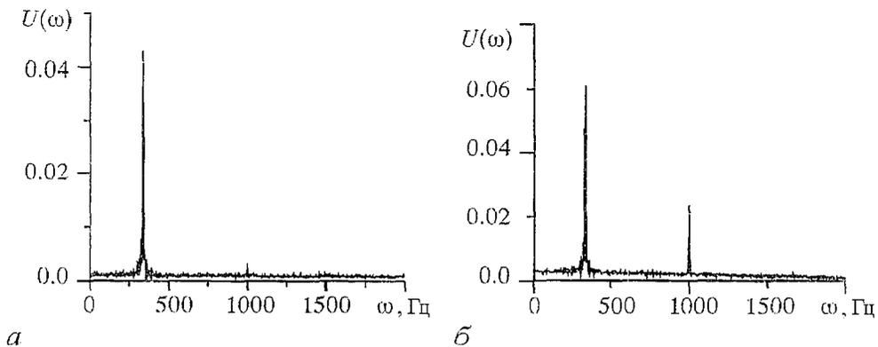
Рис. 8. Входной (а) и выходной (б) спектры при выделении квазигармонического сигнала из шума при амплитуде субгармоники равной трети порога переключения; частота переключений шумом в отсутствие сигнала равна частоте сигнала
