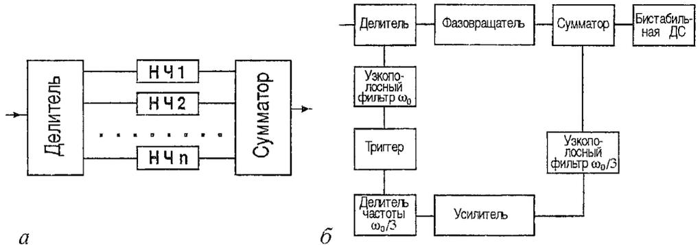
Рис. 7. Схемы для увеличения выходного SNR: а – с  $n$  разветвлениями для снижения КШ; б – пороговая схема обнаружения квазигармонического сигнала
