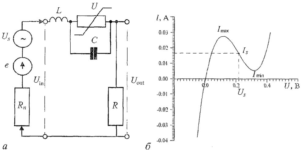
Рис. 1. Нелинейный элемент, емкость  $C$  и индуктивность  $L$ , включенные в четырехполюсник, моделирующий туннельный диод (а) и ВАХ нелинейного элемента (б) при  $R_1=6$  Ом.  $U_0=0.1$  В,  $U_s=0.21$  В,  $I_s=0.01645$  А,  $e=0.35805$  В
