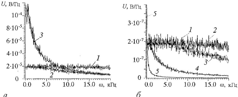
рис. 2. Спектры входного сигнала (кривая 1) и напряжений на нелинейном элементе (кривые 2–5): а – в окрестности точки перегиба ВАХ при  $D=0.01$  для  $R_c=0.01$ ,  $C=1.25\cdot 10^{-2}$  (кривая 2),  $R_c=5$ ,  $C=1.25\cdot 10^{-2}$  (кривая 3); б – в окрестности максимума на ВАХ при  $D=0.0001$ ,  $R_c=9$  для  $C=0$  (кривая 2),  $C=5\cdot 10^{-6}$  (кривая 3),  $C=5\cdot 10^{-5}$  (кривая 4),  $C=2\cdot 10^{-3}$  (кривая 5)
