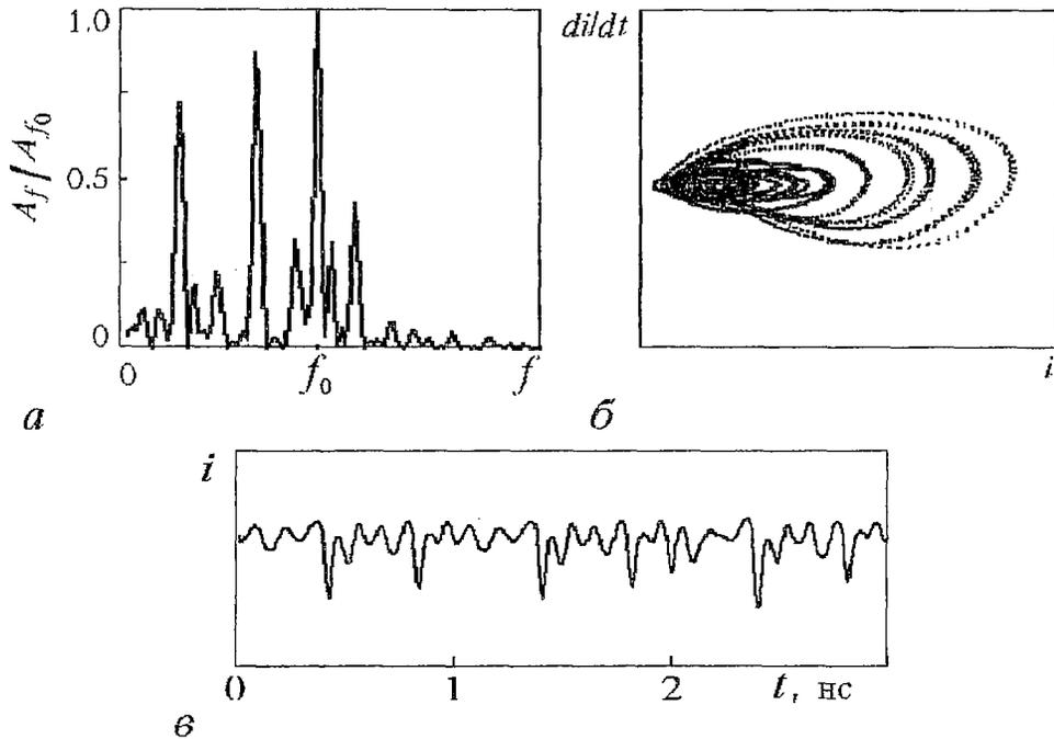
Рис. 5. Спектр выходного сигнала (а), фазовый портрет колебаний (б) и зависимость мгновенных значений тока, протекающего через диод Ганна, от времени (в) при напряжениях питания, близких к пороговому;  $\epsilon=3.425$  В,  $C_2=0.3$  пФ,  $L_4=0.5$  нГн
