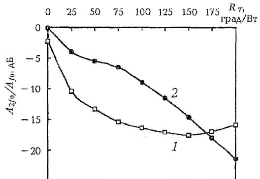
Рис. 3. Зависимости относительной мощности второй гармоники выходного сигнала от величины теплового сопротивления прибора  $R_T$  для различных значений  $R_0$ : 1–10 Ом, 2–7.5 Ом;  $\epsilon = 6$  В,  $C_2 = 0.03$  пФ,  $L_4 = 0.1$  нГн
