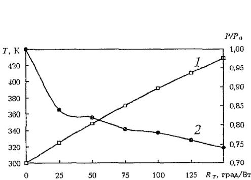
Рис. 2. Зависимости температуры кристалла диода Ганна (кривая 1) и выходной мощности генератора (кривая 2) от величины теплового сопротивления  $R_T$ :  $\epsilon = 8$  В,  $C_2 = 0.3$  пФ,  $L_4 = 0.01$  нГн
