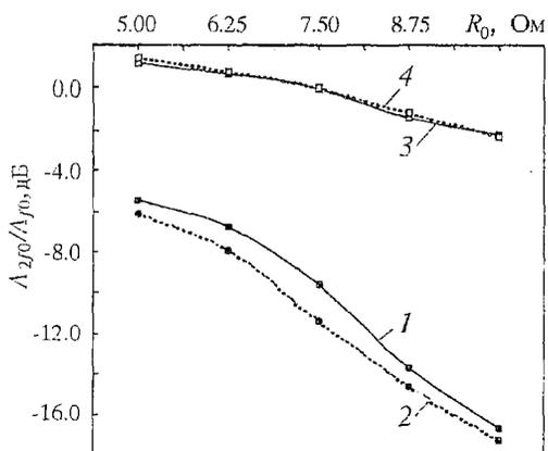
Рис. 4. Зависимости относительной мощности второй гармоники от сопротивления диода  $R_0$  для различных температур окружающей среды  $T_0$ , К: 1–300, 2–310 с учетом саморазогрева ( $R_T=100$  град/Вт) кристалла диода Ганна; 3–300, 4–310 без учета саморазогрева ( $R_T=0$ )
