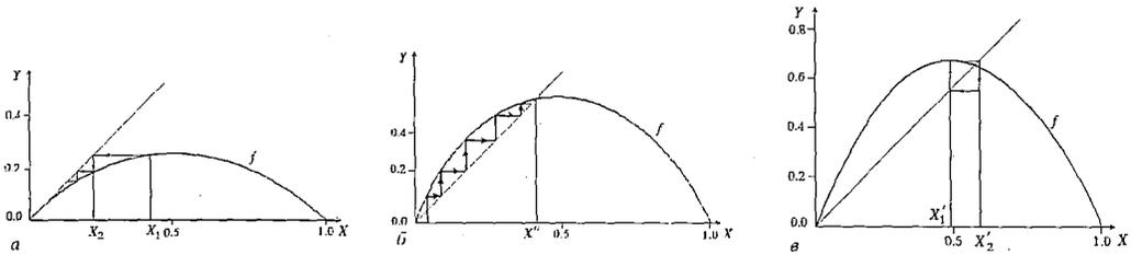
Рис. 1. Отображение первого возвращения для последовательности, формируемой уравнением (6) [5]: а -  $A=1.0$ ; б -  $A=2.0$ ; в -  $A=3.236$
