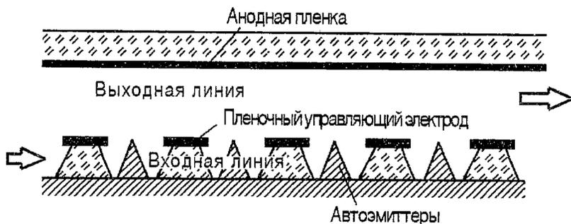
Рис. 10. Схема микрораспределенного усилителя с решеткой автоэмиссионных катодов
