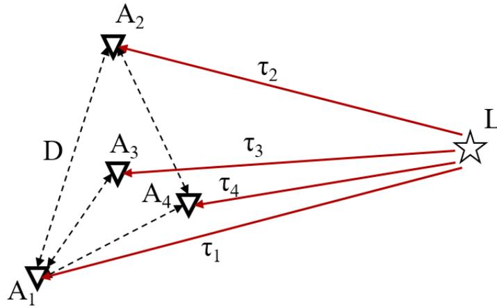
Рис. 3. Схема корреляционного приема радиосвета в трехмерном пространстве для четырёх антенн. А — антенна, L — лампа радиосвета,  $\tau$  — время распространения электромагнитного излучения от лампы до приемных антенн
