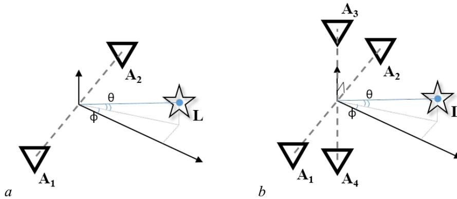
Рис. 1. Расположение приёмных элементов для случая: *a* – двух антенн; *b* – четырёх антенн
