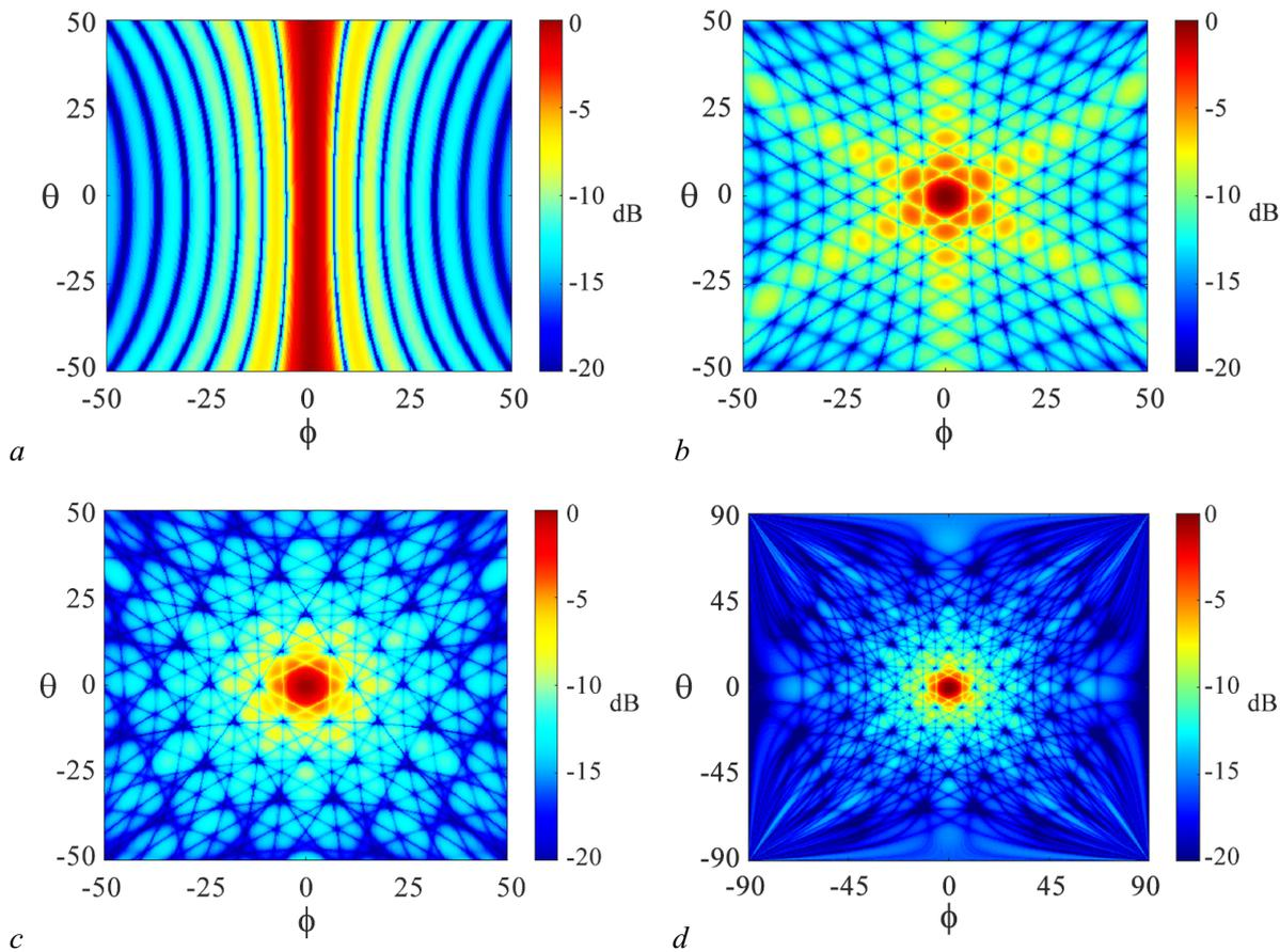
Рис. 6. Отклик корреляционного приемника радиосвета при использовании: *a* — двух антенн; *b* — трех антенн; *c* — четырех антенн; *d* — четырех антенн для расширенной области с углами  $\phi$ ,  $\theta$  в диапазоне  $[-90^\circ, 90^\circ]$  (цвет онлайн)
