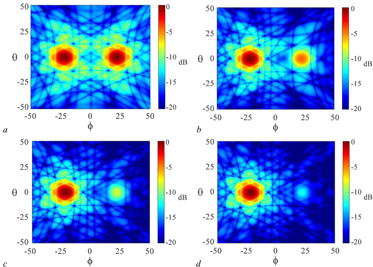
Рис. 8. Отклик приёмной системы после применения оконной функции Кайзера на наличие двух ламп радиосвета при ослаблении одной из ламп относительно другой на:  $a - 0$  дБ;  $b - 4$  дБ;  $c - 8$  дБ;  $d - 12$  дБ (цвет онлайн)
