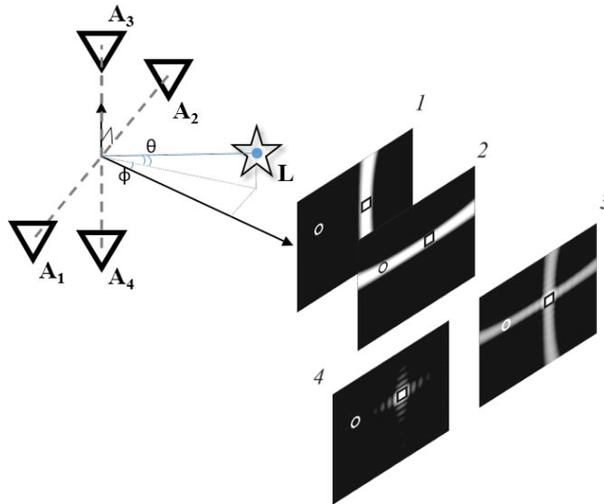
Рис. 2. Пример построения изображения на основе комбинации двумерных откликов. 1 – визуализация отклика  $R_{12}$ , 2 – визуализация отклика  $R_{34}$ , 3 – визуализация итогового отклика  $R$  как среднего арифметического для  $R_{12}$  и  $R_{34}$ , 4 – визуализация итогового отклика  $R$  как среднего геометрического для  $R_{12}$  и  $R_{34}$
