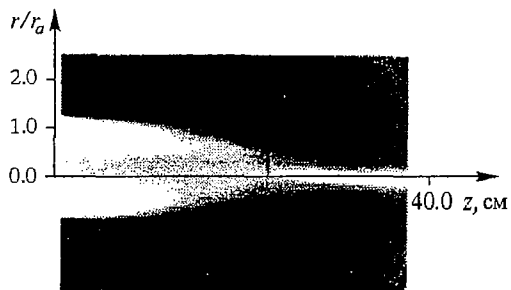
Рис. 1. Структура ВЧ-разряда, формируемого в результате ионизационного самоканалирования плазменных волн в продольном магнитном поле B_0 = 500 Гс при p = 2 \times 10^{-2} Торр, f = 200 МГц, V_0 = 50 В; z – расстояние от дипольного источника, формирующего разряд, r_a – радиус возбуждающих колец источника
