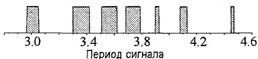
Рис. 11. Диаграмма синхронизации режима nT_s : nT^1 : 0 без разделения по n при A = 0.97, \epsilon = 0.003, C = 0.2 , амплитуда сигнала A_s = 0.05
