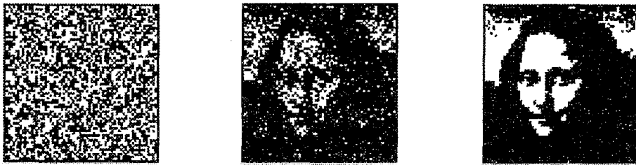
Рис. 3. Формирование фазовых кластеров в ансамбле N = 6536 генераторов. Цветом обозначены фазы генераторов, для наглядности элементы выстроены в решетку 66 \times 66 . Начальный (а), промежуточный (б) и конечный моменты времени (в)
