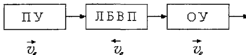
Рис. 5. Схема включения ЛБВП в качестве невязанного развязывающего устройства в усилительную цепочку между предусилителем (ПУ) и оконечным усилителем (ОУ); стрелками показаны направления скоростей движения электронов v_e во всех элементах усилительной схемы
