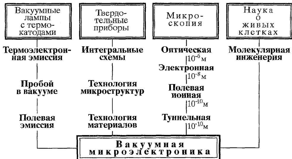
Рис. 1. Схема, иллюстрирующая тезис А.Броди о четырех путях развития вакуумной микроэлектроники
