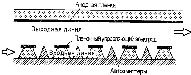
Рис. 10. Схема микрораспределенного усилителя с решеткой автоэмиссионных катодов
